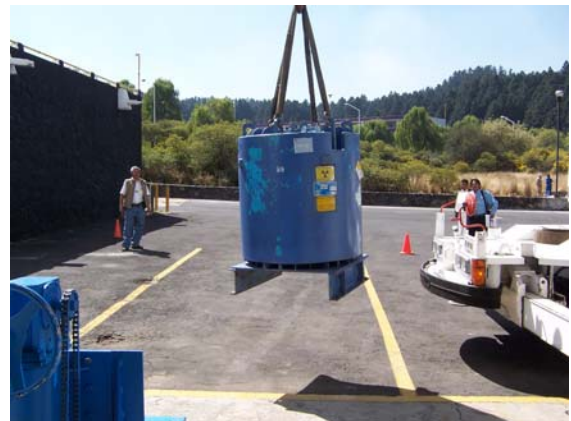
Descarga del contenedor en donde se transportó el Co 60
